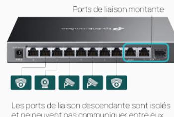
\*La vitesse des ports en mode Extend sera réduite à 10 Mbit/s. La distance de transmission réelle peut varier en fonction de la qualité du câble.
